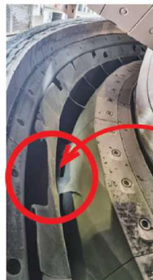
히타치 MPS Type Inner Segment Vane 문제점
