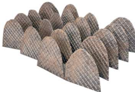
5. Elbow 마모부위 초경 용접
