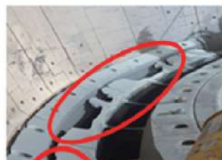
히타치 MPS Type Inner Segment Vane 문제점
