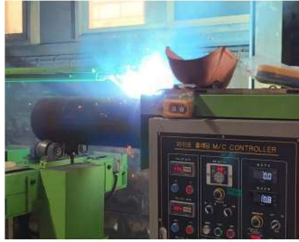
파이프 외부 초경 용접
