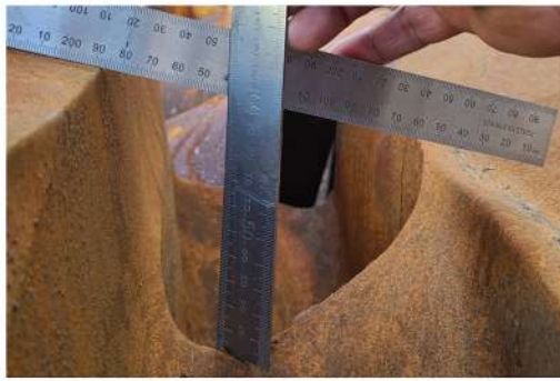
기존 vane 제품 마모량 측정
