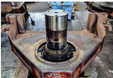
7. SHAFT & YOKE 내부 CLEANING
