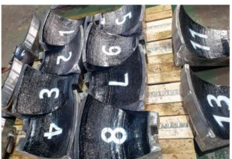
22. BULLRING SEGMENT 도장 및 넘버링 작업
