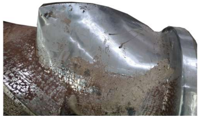
Rotor 날개 마모부 확인
