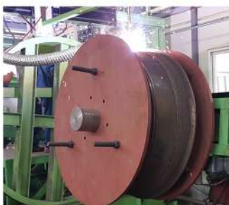
04 육성 용접 작업
