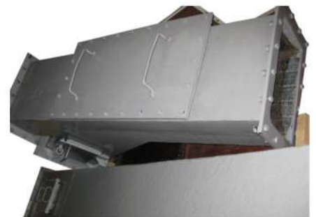
초경 Inlet Chute 제작
