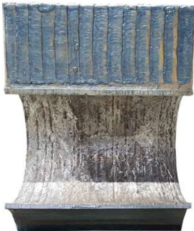
Chamber 초경 용접 후
