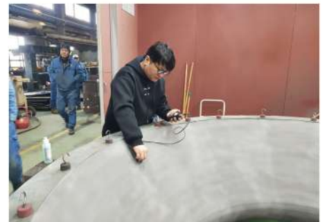
9. 용사코팅 후 두께측정
