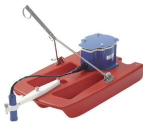
유량 측정 및 단면 측량 (StreamPro ADCP)
