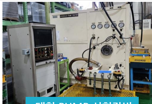
대형 PUMP 시험장비
